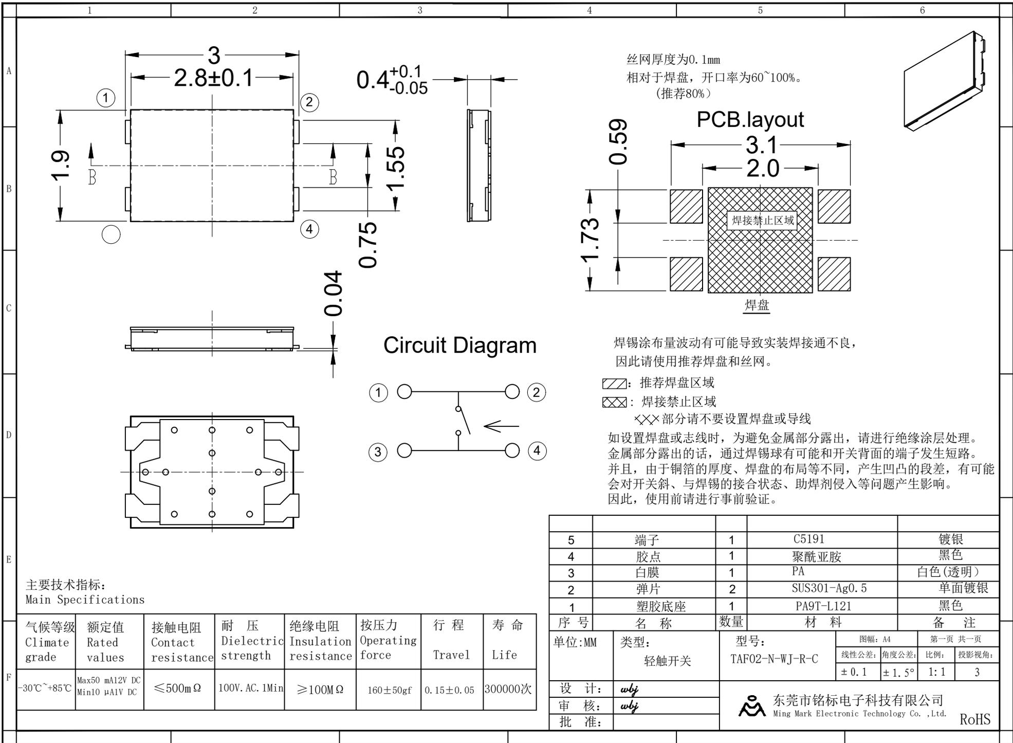
焊锡涂布量波动有可能导致实装焊接不良，因此请使用推荐焊盘和丝网。
